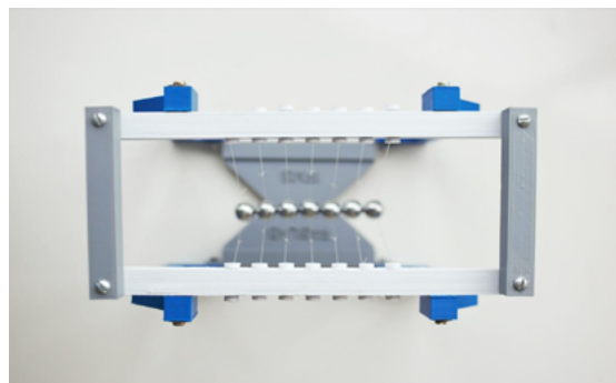
Figura 1 - Pêndulo de Newton - Modelado utilizando o software OpenScad e produzido por meio da impressão 3D, tendo como matéria prima, filamento do tipo ABS (Acrilonitrila butadieno estireno) – Autoria Própria.
