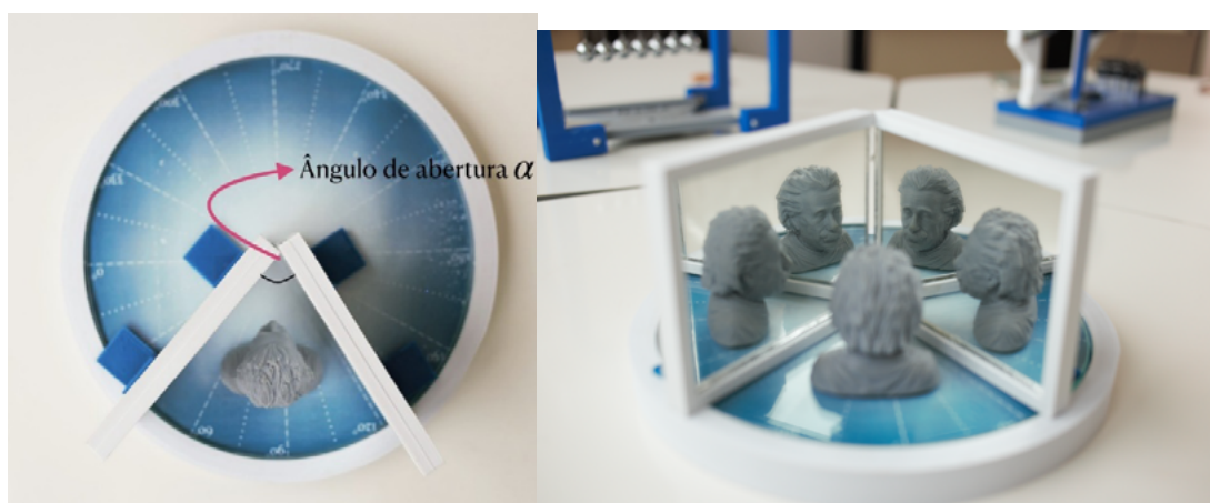
Figura 3 - Ângulo de abertura entre os espelhos (esquerda). Associação de Espelhos Planos - Modelado utilizando o software OpenScad e produzido por meio da impressão 3D, tendo como matéria prima, filamento do tipo ABS (Acrilonitrila butadieno estireno) – (direita) – Autoria Própria.
