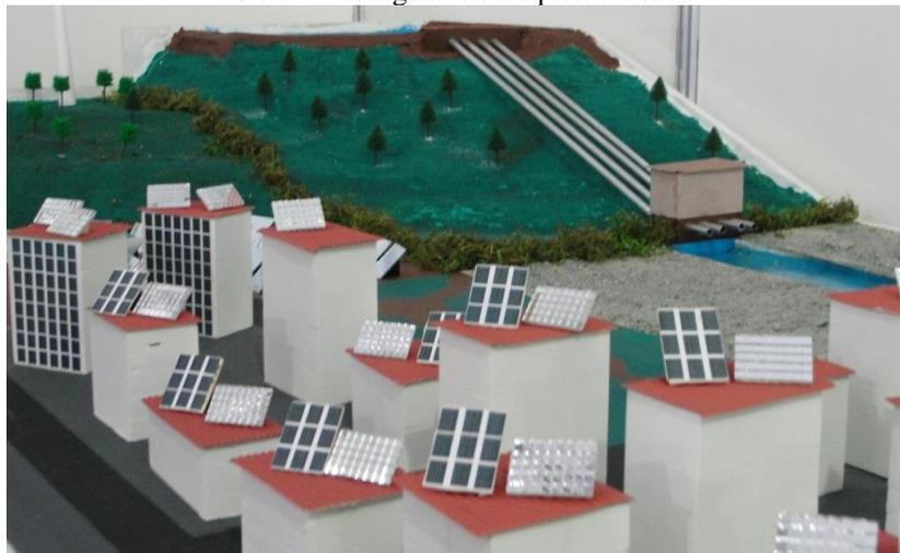
A maquete técnica, por sua vez, concentrou na estruturação de um modelo reduzido de um sistema solar fotovoltaico real. A maquete técnica teve por objetivo principal proporcionar aos alunos do projeto a vivência da técnica envolvida nessa forma de geração. Uma vez que os alunos são estudante de um curso de formação técnica – eletrotécnica – procurou-se trabalhar com dispositivos reais que implementassem os conceitos estudados.
