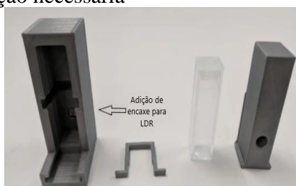
Figura 7: Modelo de suporte para cubeta e adaptação necessária
