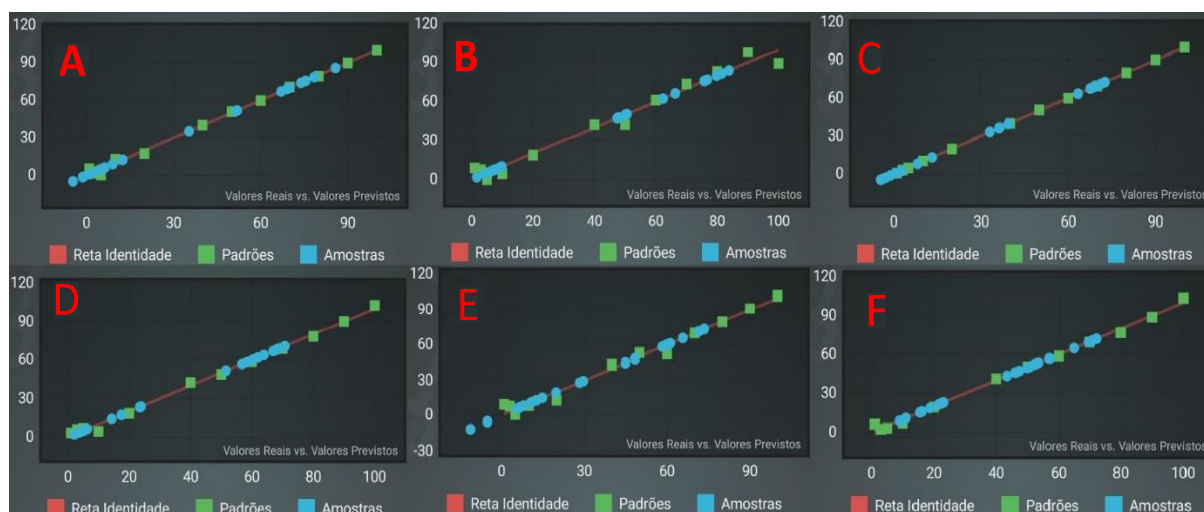
FIGURA 4: Gráfico de Previsão de Modelo para Amostra de EVOO 1 adulterado com diferentes OVs sendo (A) Soja; (B) Girassol; (C) Canola; (D) Algodão; (E) Milho; (F) Misto (Blend).
