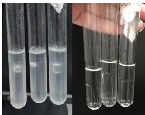
Figura 08 - Resultado do teste presuntivo com caldo lactose na amostra de chafariz B (à esquerda) ao lado do controle (à direita).
