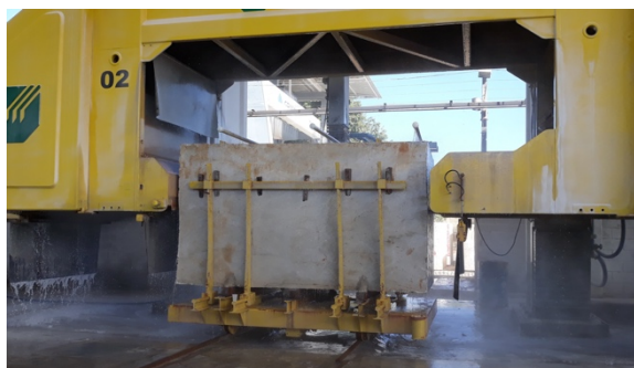
Figura 2 – Serragem de bloco
