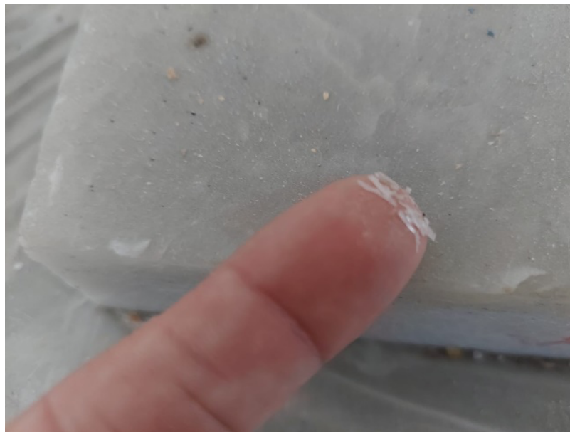
Figura 4: Sais provenientes das reações entre solução removedora de manchas e minerais constituintes da rocha na superfície da amostra.
