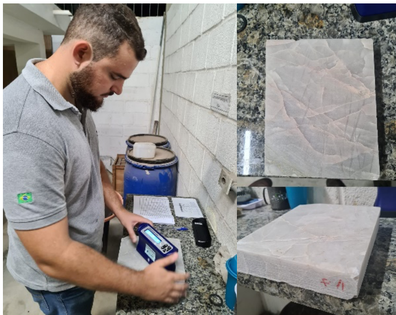
Figura 1: Medição do brilho e registro das amostras por fotografia.
