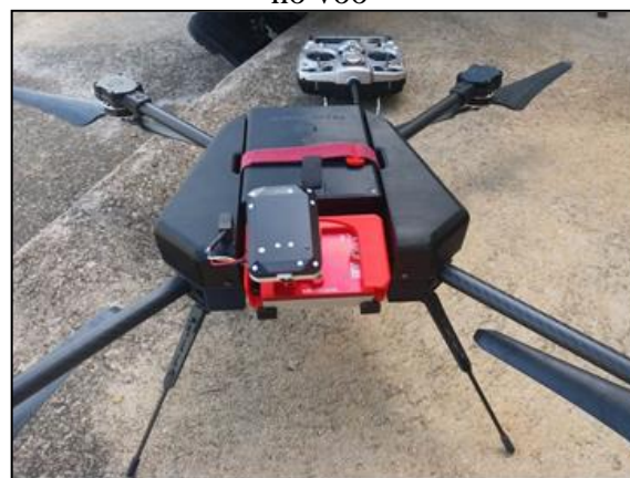
Figura 3 – Aeronave Remotamente Pilotada e sensor multiespectral utilizado no voo
