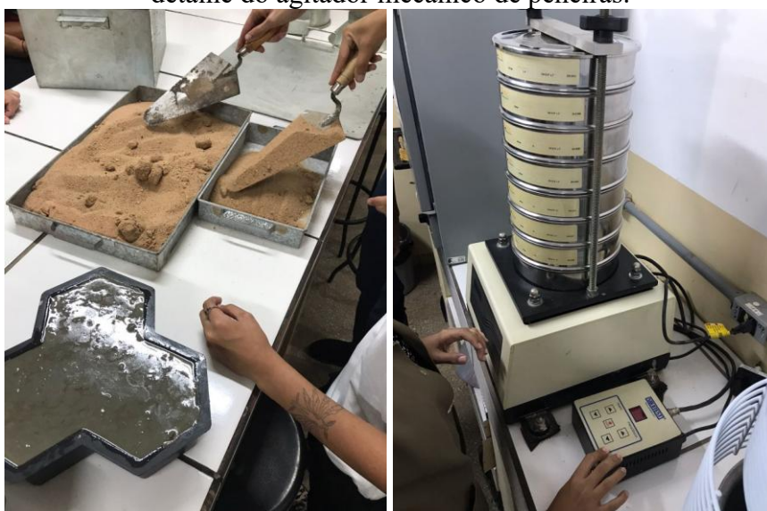
Figura 3 – Amostras de areia para realização dos ensaios de composição granulométrica e detalhe do agitador mecânico de peneiras.
