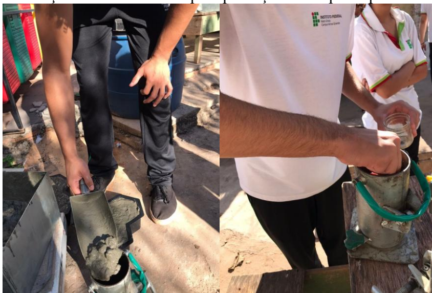
Figura 4 – Preparação do molde para realização do ensaio de corpos de prova cilíndricos e lançamento do concreto para produção do corpo de prova.
