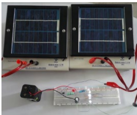
Figura 3 – Circuito da primeira versão da Lanterna montado em matriz de contatos.
