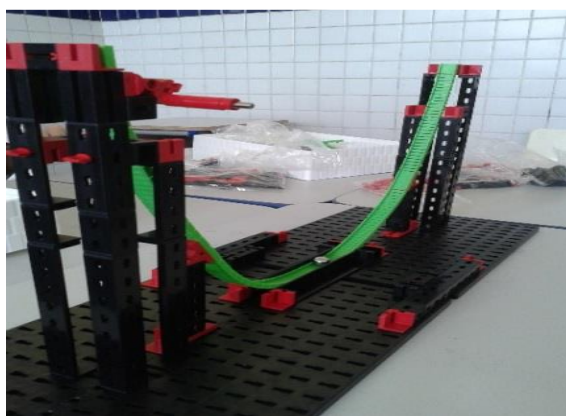
Figura 2: Montagem de Robótica Educacional destinada ao estudo da Energia Mecânica. Fonte: Autores
